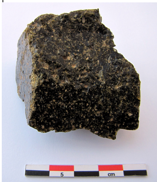
Figure 42 a et b : Vue de détail d’un lingot de verre (à gauche) et d’un bloc de verre issu de déchets de verre recyclés (à droite)
